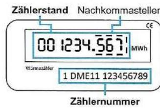
**Wärmemengenzähler:** Bitte Zählerstand mit MWh mit 3 Nachkommastellen angeben.
